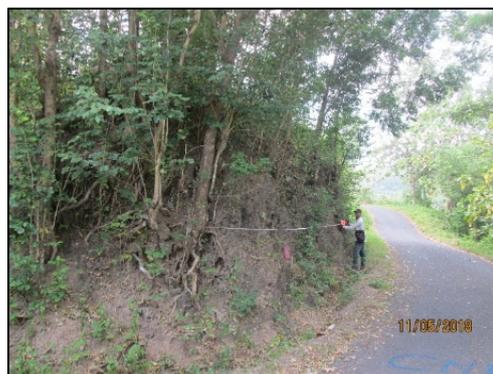
Gambar 8. Kenampakan lereng andesit dengan struktur kekar berlembar pada pinggir jalan LP S05
